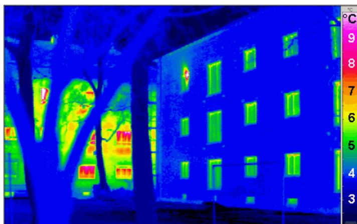
Cette thermographie montre à gauche un bâtiment ancien non isolé (derrière les arbres) et à droite une façade très bien isolée après coup (20 cm isolation):
